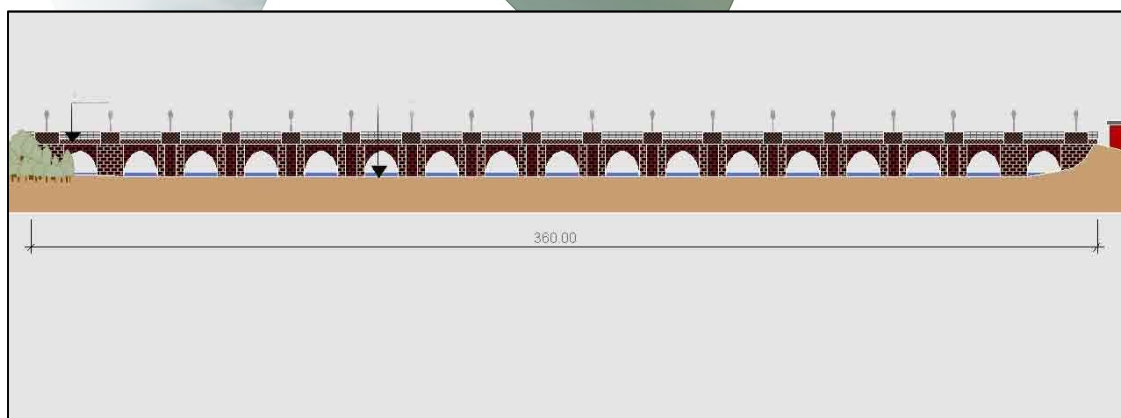
Ilustración 11. Esquema de medición de la sección de la estación de aforo de la CHE en el río Ebro en Tudela.
